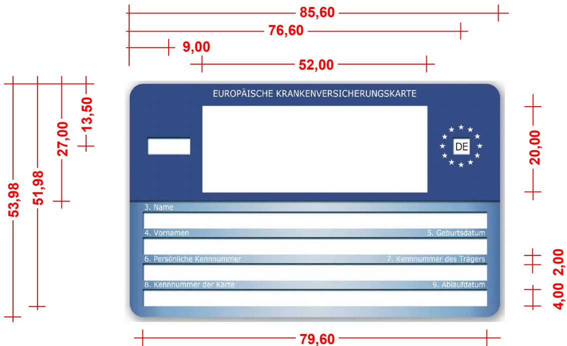
Abbildung 9: Kartenrückseite gemäß EU-Vorgabe, Abmessungen in mm
