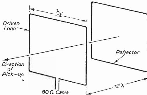
Fig. 3.—The cubical quad aerial.
